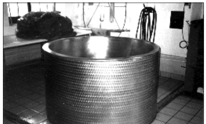
Das Herzstück der neuen Anlage ist das neue Käsekessi, das wie bis anhin mit Holz beheizt wird.
